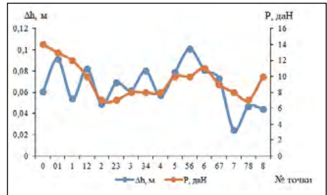
Рис. 1. Результати натурних досліджень взаємодії контактної підвіски ПБСМ-95+МФ-100 зі струмоприймачем ТЛ-13У
