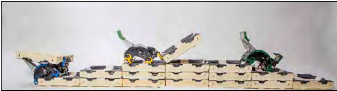
Рис. 5. Роботи, що працюють за програмою TERMES [4]
